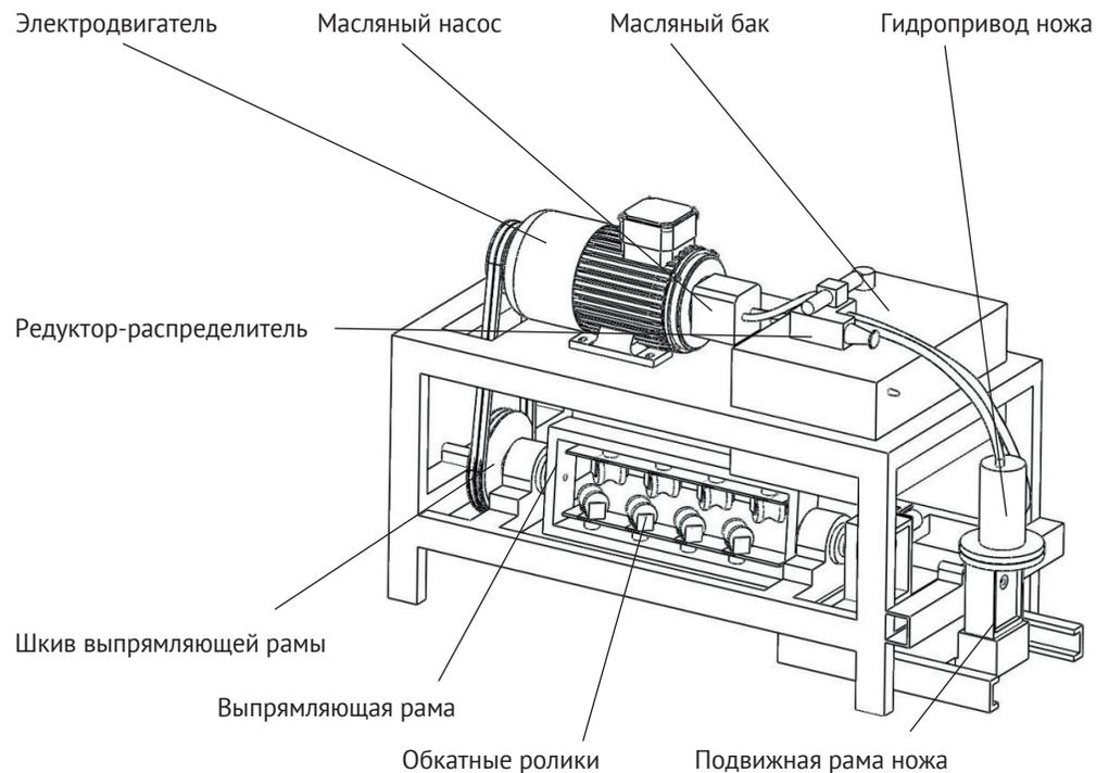
Рис. 1 Устройство ВПК ПРО-12
